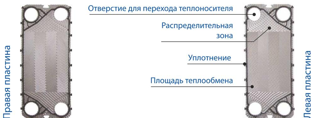
Пластинчатый теплообменный аппарат состоит из пластин одного типа или их комбинации. Количество пластин в теплообменном аппарате и их компоновка, зависит от тепловой мощности, теплофизических свойств сред, а также температурных параметров и допустимой потери давления.
